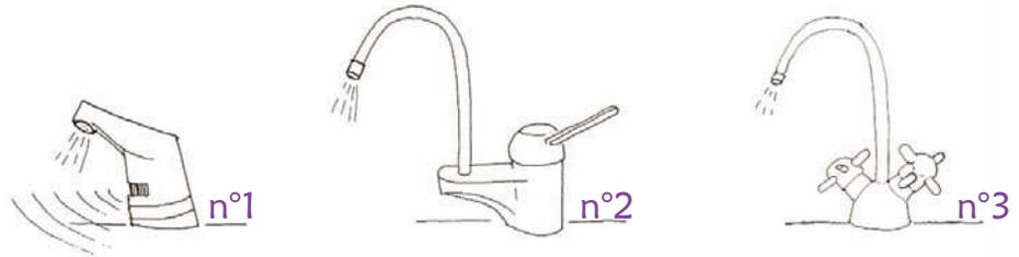
La commande la plus performante car la plus simple reste celle à **infrarouge** (dessin 1). Les robinets de type mélangeur thermostatique (dessin 2) permettent un **réglage précis et constant de la température** de l'eau pour éviter les brûlures. Pour les robinets à levier ou à tourner (dessins 2 et 3), les commandes doivent permettre une prise en main aisée.
